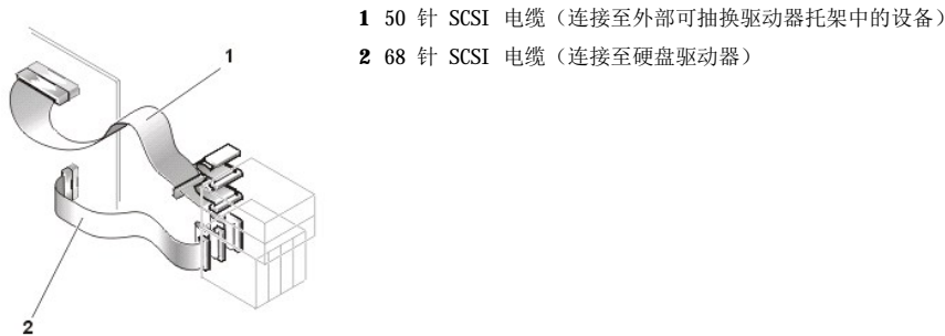
图 14. 内部 SCSI 电缆
